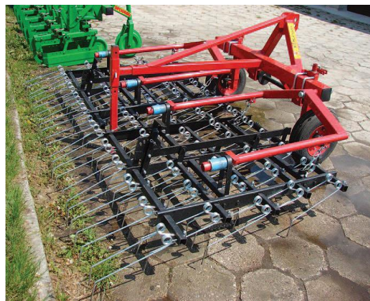
Zdj. 1. Po lewej stronie brona chwastownik (siatkowa), po prawej brona drgająca ang. nazwa „weeder harrow” oznacza po prostu bronę na chwasty/chwastową). Fot. CDR O/Radom.
