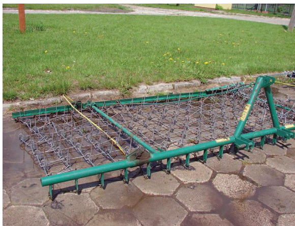
Zdj. 1. Po lewej stronie brona chwastownik (siatkowa), po prawej brona drgająca ang. nazwa „weeder harrow” oznacza po prostu bronę na chwasty/chwastową). Fot. CDR O/Radom.
